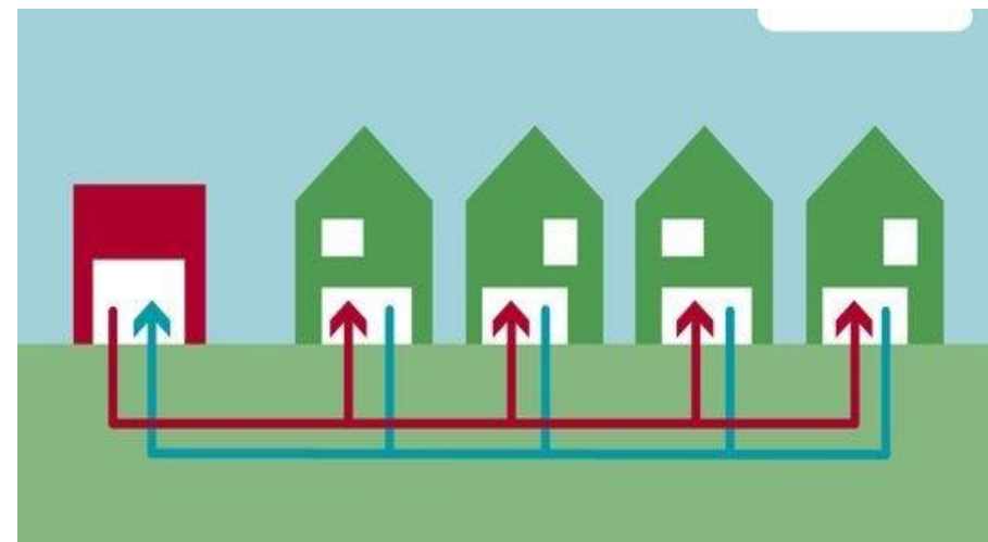
Collectieve oplossing met warmtenet
